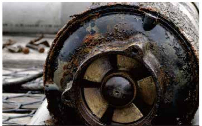
使用一年後泵浦鑄件未被侵蝕，但陽極片已侵蝕完畢，建議陽極片剩下四分之一時就要更換，以免失去保護效果。
